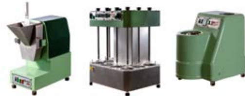
Impianto in microscala per estrazione di olio di oliva vergine
