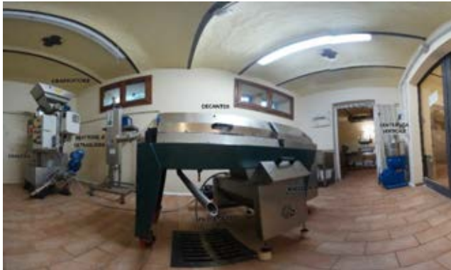
Impianto semi-industriale per estrazione di olio di oliva vergine
